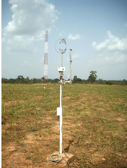
**Abbildung 1: Turbulenzmesskomplex M3 mit METEK USA-1 Ultraschallanemometer und Campbell KH20 Kryptonhygrometer, 15m Profilmast M2 im Bildhintergrund auf dem Messfeld von NIMEX-1.**
