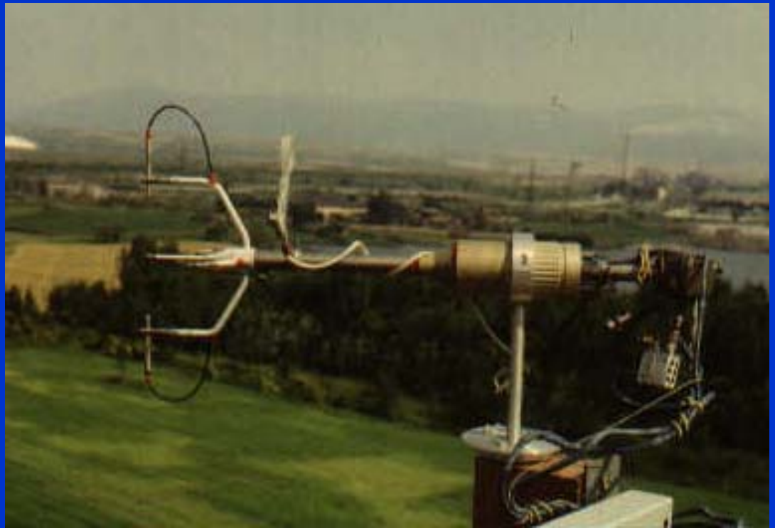
Russisches Phasenverschiebungs- Ultraschallanemometer (modernerer Typ, 1986)
