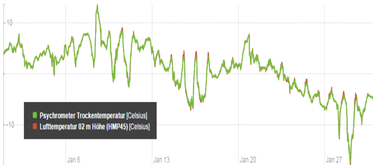
Abbildung 6: Ausschnitt aus dem Temperaturverlauf der Datenreihen Psychrometer und HMP45. Man betrachte, dass die rote Linie des HMP45 fast vollständig von der grünen Linie des Psychrometers überdeckt wird; ein Zeichen dafür, dass die Daten nahezu identisch sind.
