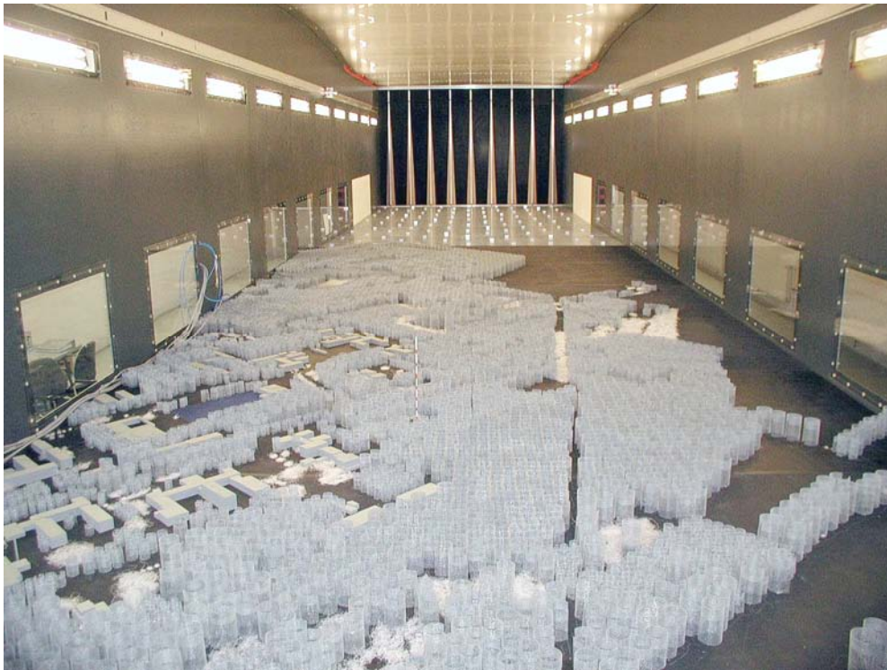
Abbildung 53: Windkanalmodell der untersuchten Waldfläche 'Stetterner Forst' am Forschungszentrum Jülich.
