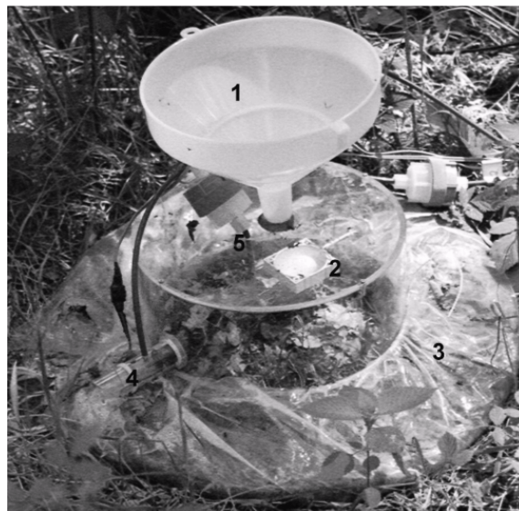
Abbildung 33: Aufbau der dynamischen Kammer an der Messstelle ("Westturm", Stettericher Forst, Forschungszentrum Jülich).
